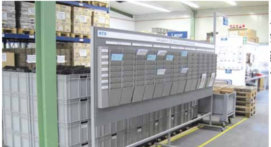
Hier laufen die Materialströme zusammen: Auftragsboard mit angeschlossenem Materialbahnhof
